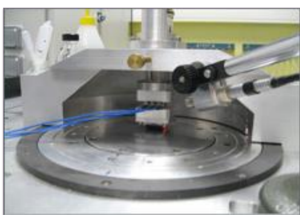
Module « cloche » installé sur le banc LUG avec un échantillon de courroie
