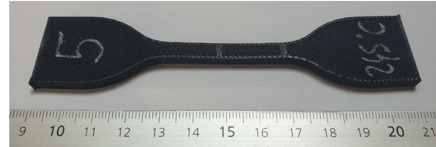
Eprouvette haltère de traction d'un échantillon de Flex93
