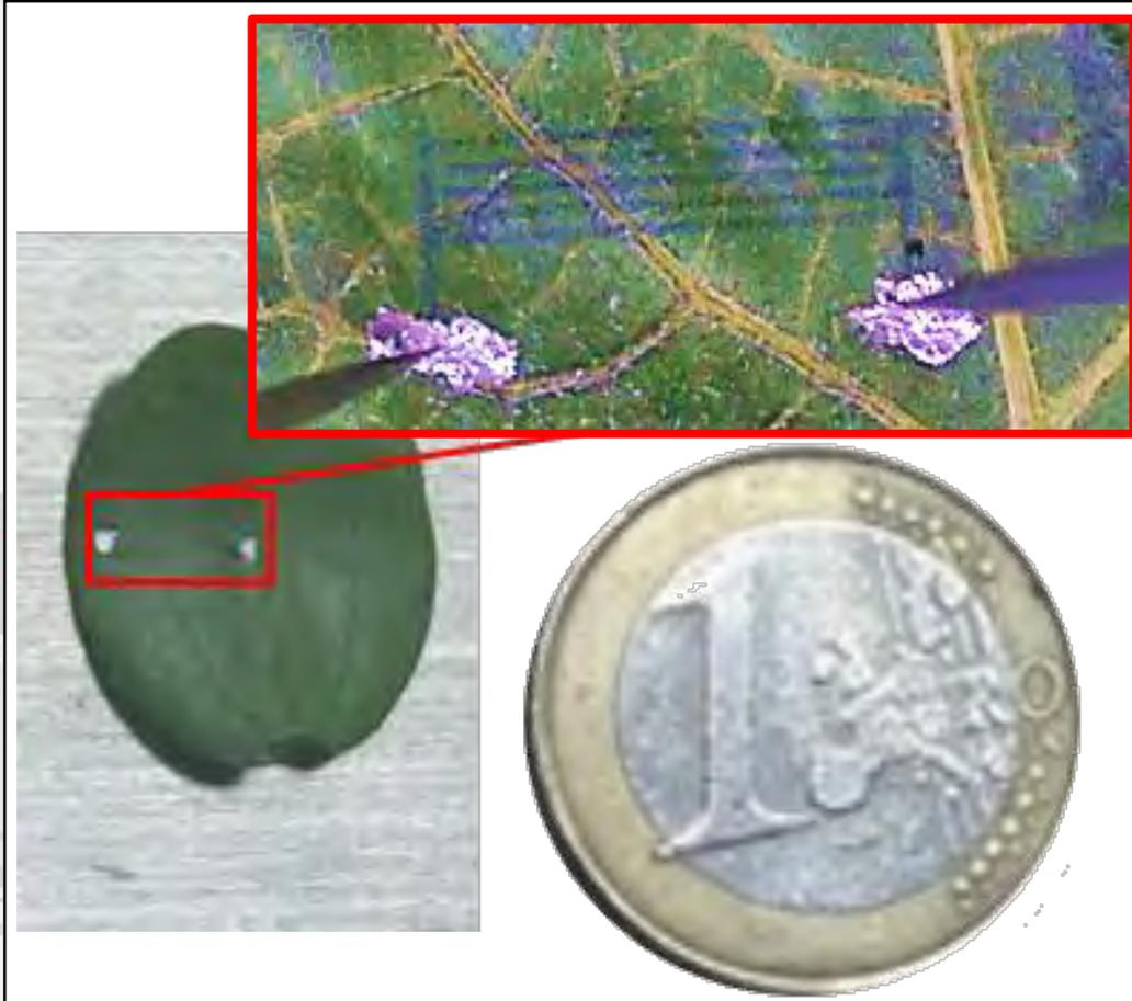
Transistors EGOFET totalement imprimés
