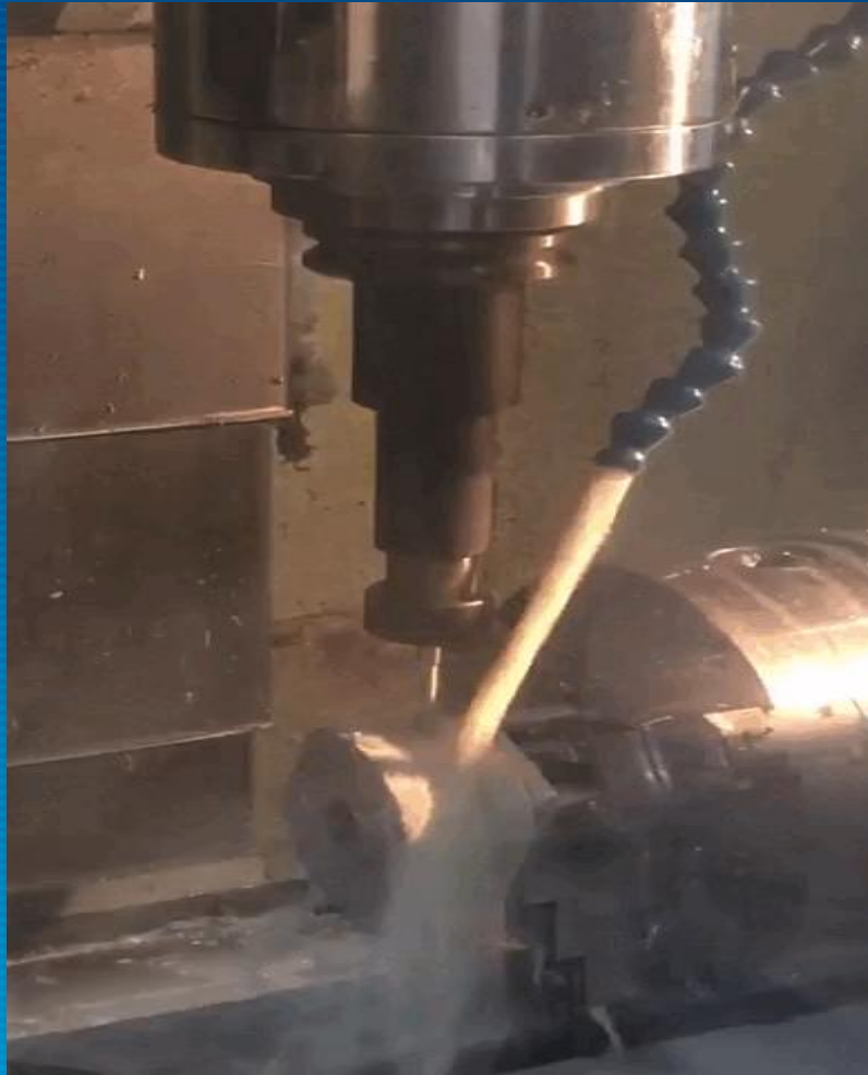
Usinage du corps du compresseur
