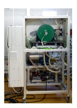
Moteur de détente à piston technologie non lubrifiée
